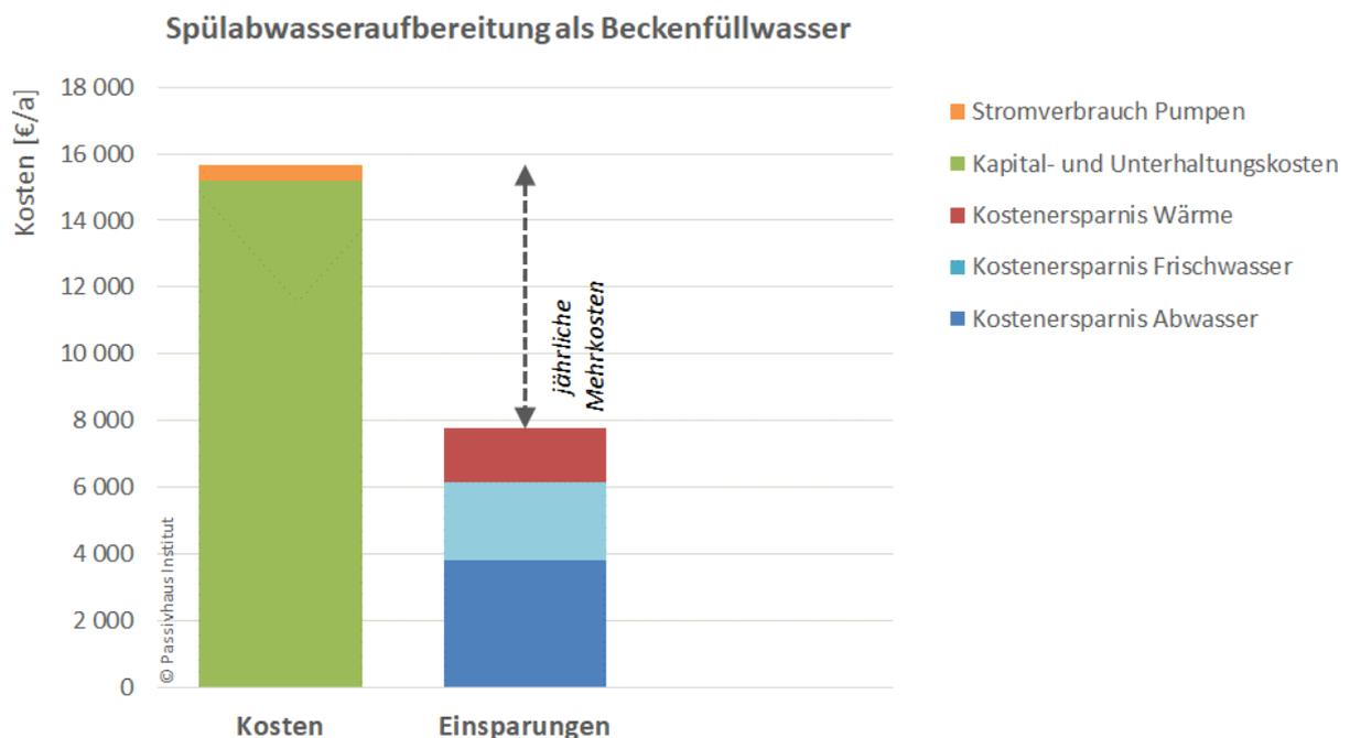
**Abb. 99: Beispiel einer Kosten-Nutzen-Analyse einer Filterspülabwasseraufbereitung mit Nutzung als Füllwasser für den Beckenkreislauf (25m Sportbecken).**
