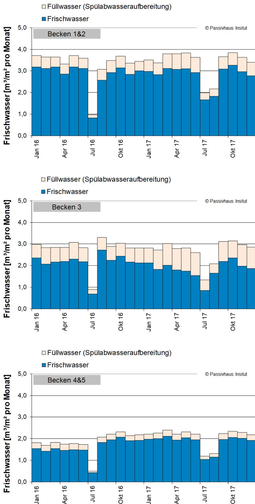
Abb. 76: Spezifischer monatlicher Wasserverbrauch pro m<sup>2</sup> Beckenfläche der drei Beckenkreisläufe im Lippe-Bad im Zeitverlauf 2016-2017.
