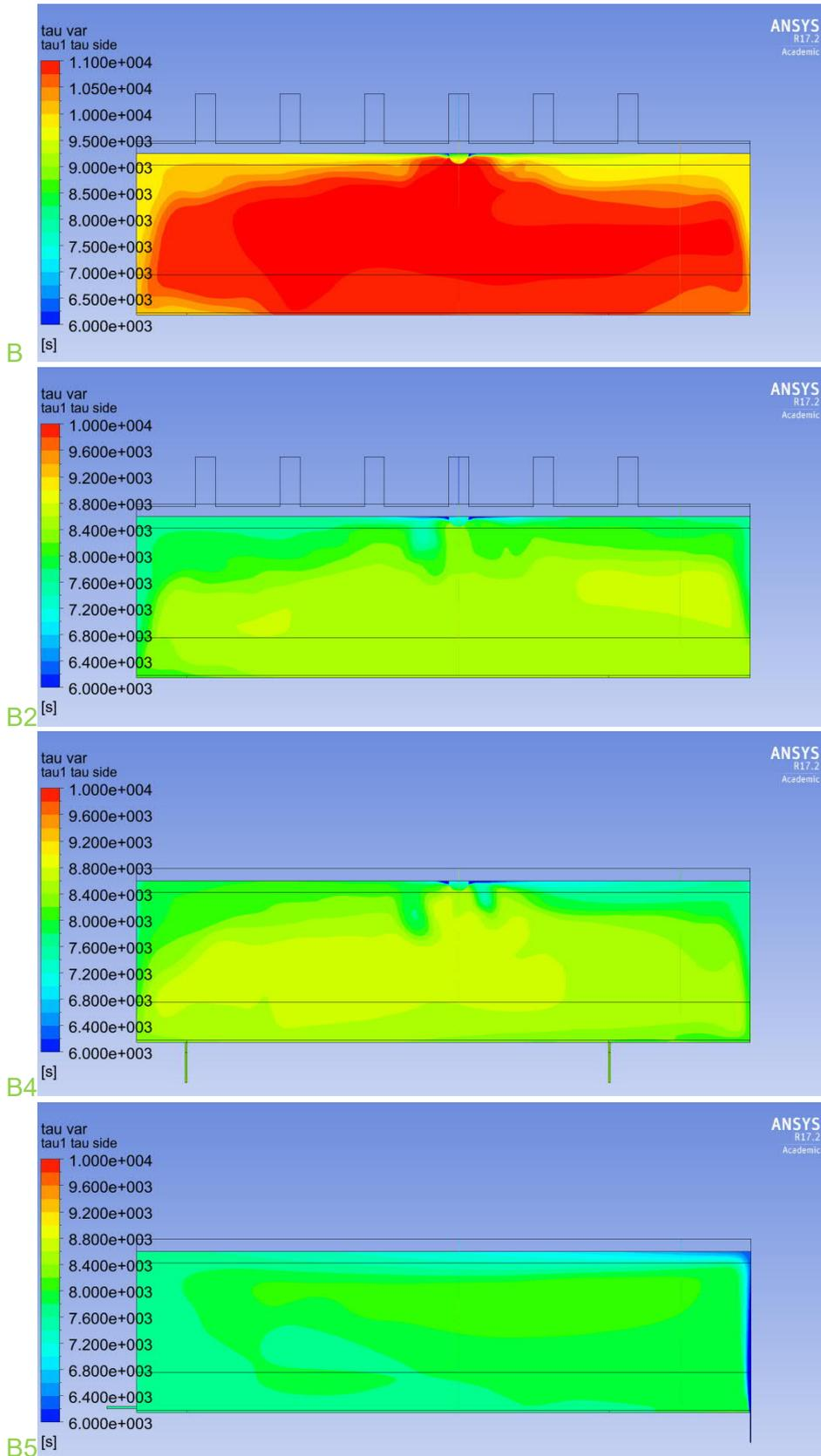
**Abb. 55:** Das berechnete Alter der Luft im Querschnitt der Halle für ausgewählte Varianten (von oben nach unten): Ausgangsvariante (B), Abluft an der Außenwand (B2), Abluft am Beckenrand (B4) und Zuluft entlang der Außenwand mit Abluft entlang der Innenwand (B5). Die Innenwand befindet sich in diesem Schnittbild auf der linken Seite.
