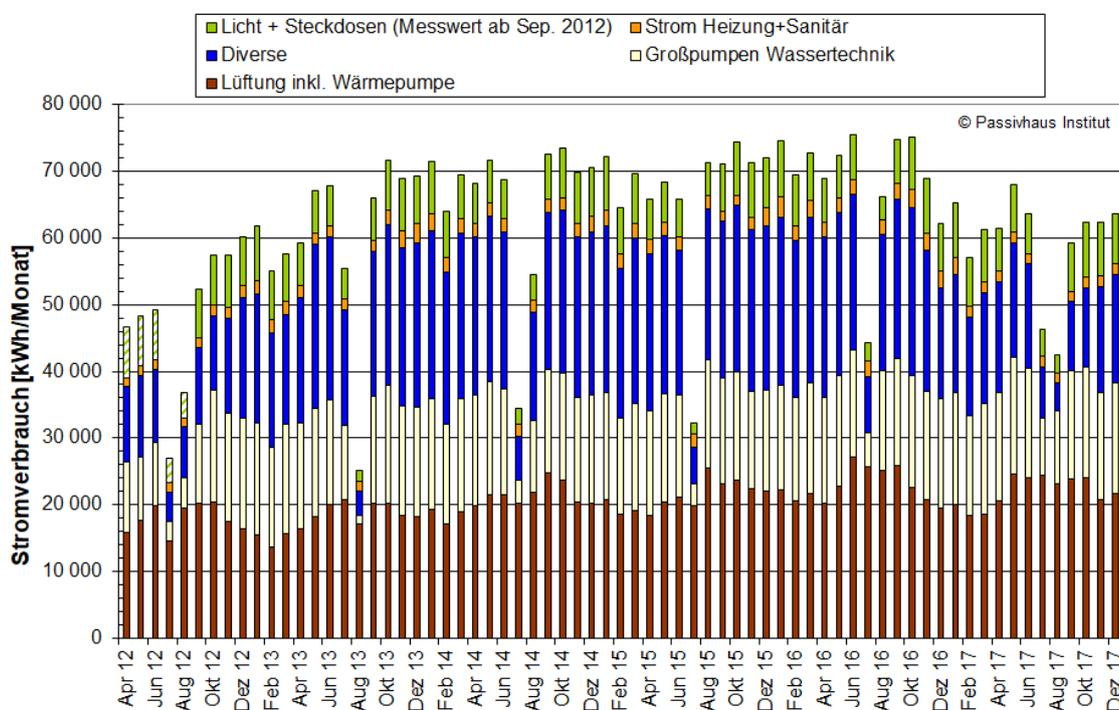
**Abb. 18: Gesamter monatlicher Strombezug des Lippe-Bades von April 2012 bis Dezember 2017 unterteilt nach den fünf Hauptverbrauchsbereichen. Bei den schraffierten Balken bis August 2012 des Bereiches "Licht + Steckdosen" handelt es sich um Hochrechnungen.**
