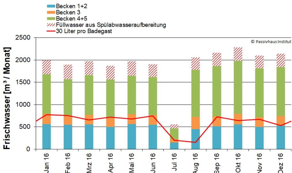
Abb. 75: Monatlicher Frischwasserverbrauch im Lippe-Bad für die drei Beckenkreisläufe im Vergleich zur hygienischen Mindestanforderung von 30 Liter/ Gast (Personenzahl basierend auf Zählung durch das Kassensystem).
