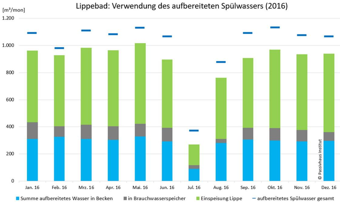
**Abb. 79: Nutzung des aufbereiteten Spülwassers in drei Nutzungsbereiche und Angabe der Gesamtmenge des aufbereiteten Spülwassers (Monatssummen). Die Differenz zur Gesamtmenge wird zur Rückspülung der Spülwasseraufbereitung selber genutzt.**
