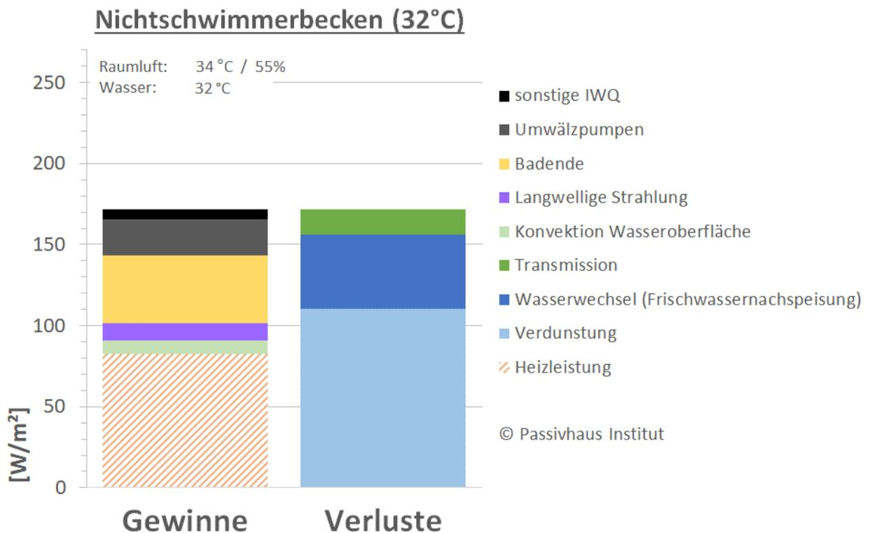
**Abb. 93: Beispiele von Energiebilanzen für ein Schwimmerbecken und Nichtschwimmerbecken. Der spezifische Heizwärmebedarf ist für Nichtschwimmerbecken auf Grund der höheren Wassertemperatur und höheren Personen-Belastung in der Regel höher.**
