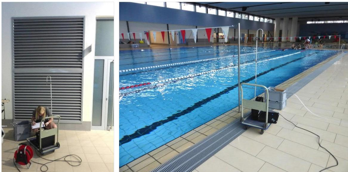
**Abb. 65:** Luftprobenahme mit Ansaugpumpen im Bad Niederheid in Düsseldorf vor dem zentralen Absauggitter (links) und über der Wasseroberfläche und im Umgang (rechts).
