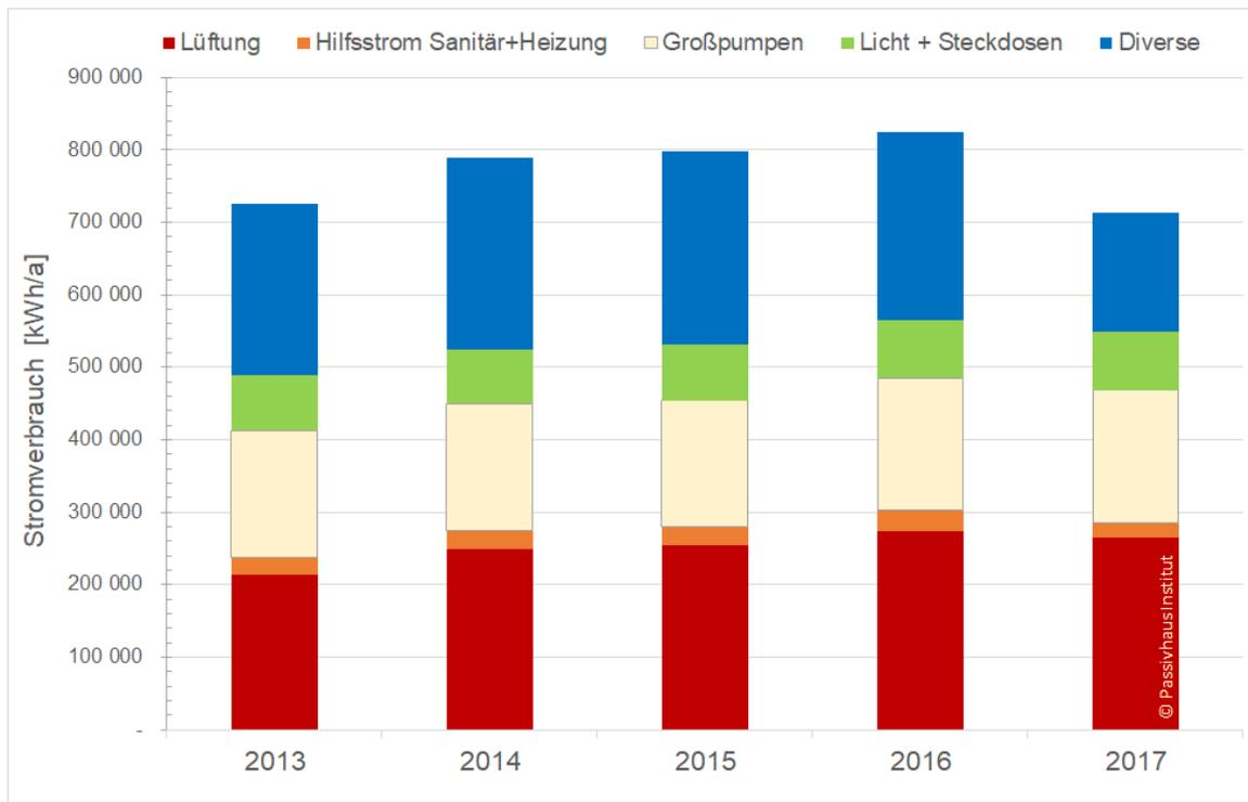
**Abb. 17: Gesamter jährlicher Strombezug des Lippe-Bades von 2013 bis 2017 unterteilt nach den fünf Hauptverbrauchsbereichen.**
