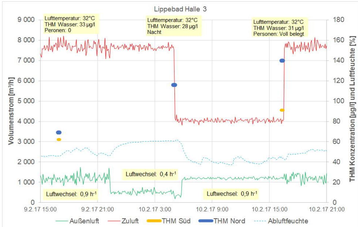
**Abb. 62:** THM Messwerte (Luft und Wasser), rel. Abluftfeuchte und Luftvolumenströme während des Messzeitraums der Halle 3 des Lippe-Bades.
