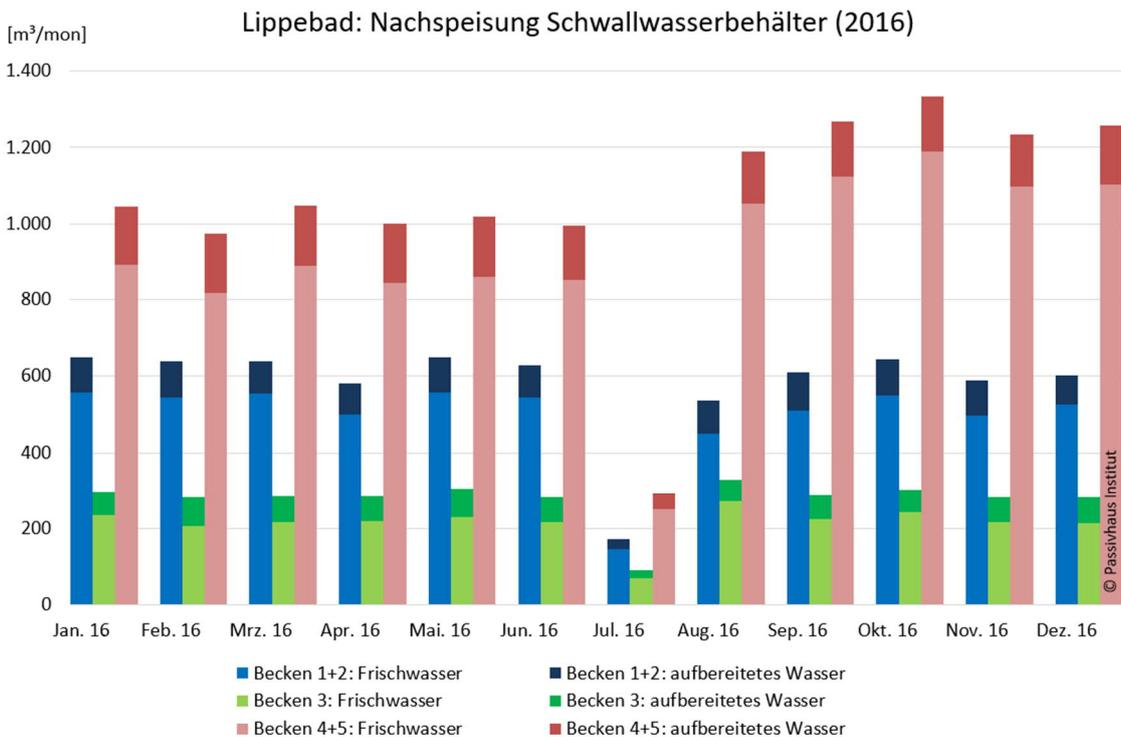
**Abb. 80: Monatsdarstellung der Beckenwassernachspeisung der drei Beckenwasserkreisläufe. Im Mittel über alle Kreisläufe deckt das aufbereitete Wasser 15 % der Nachspeisung ab.**
