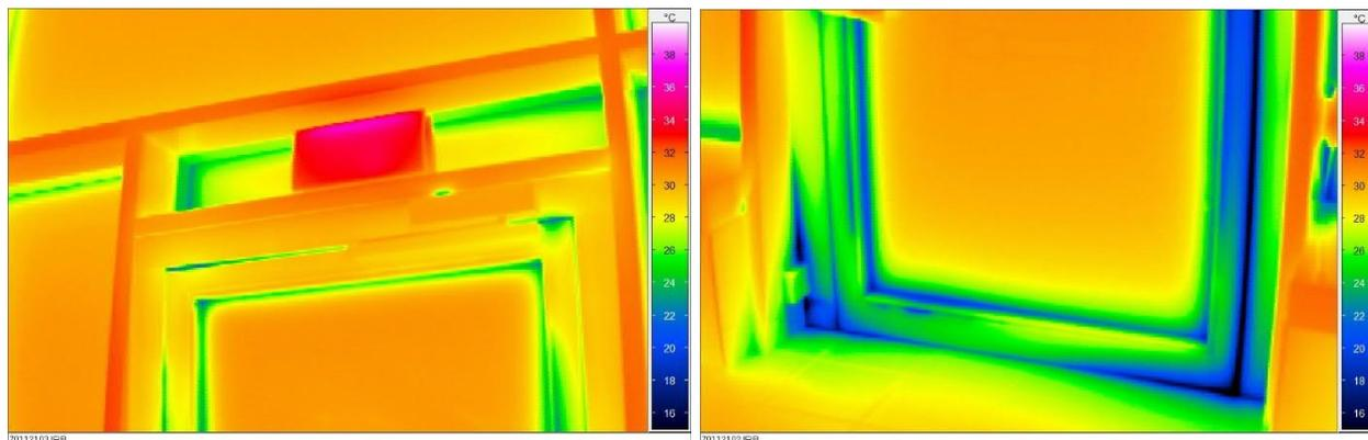
**Abb. 31:** Außentür oben (links) mit Notausgangsschild und unten (rechts) in Halle 1+2 (Südfassade).
