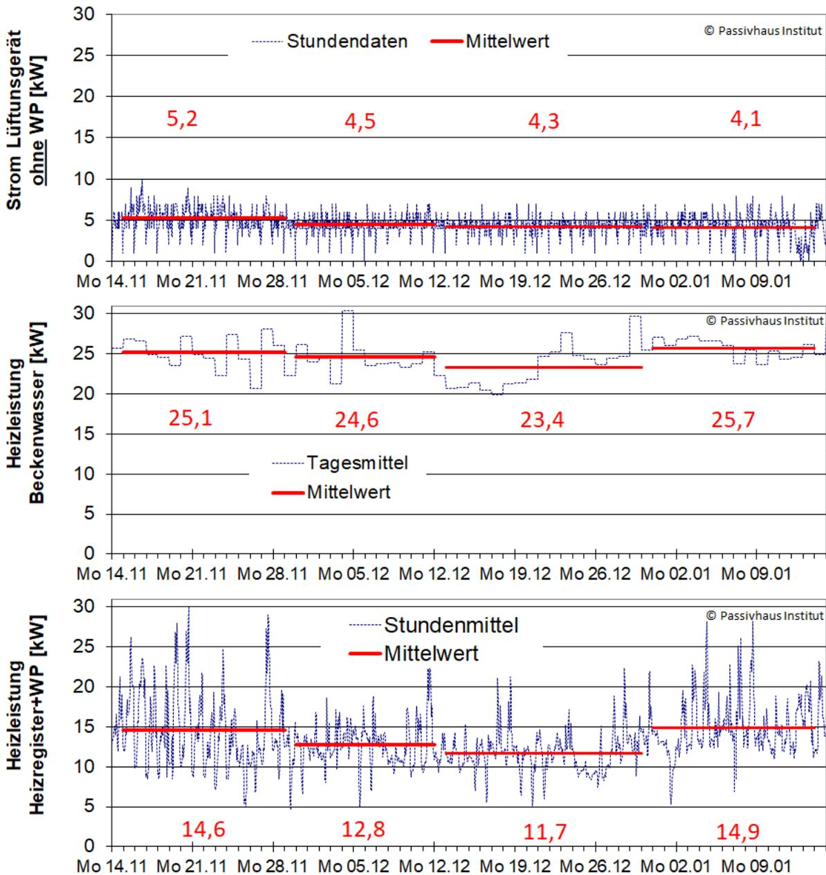
Abb. 48: Messdatenauswertung der energetischen Auswirkung bei Versuchsreihen mit veränderter Raumluftfeuchte über zwei Monate im Winter 2016/17 (siehe Abb. 47). Bei erhöhter Feuchte sinken sowohl der Stromverbrauch der Lüftung (oben), als auch die Heizleistung für das Beckenwasser (mittig) und die Raumheizung (unten).
