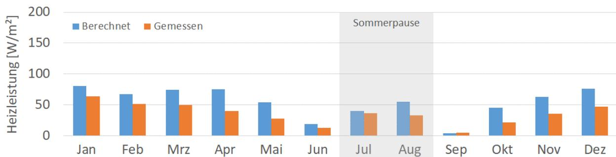
**Abb. 90: Die berechnete monatliche Heizleistung für Becken 3 im Vergleich zu den Messdaten von 2016.**
