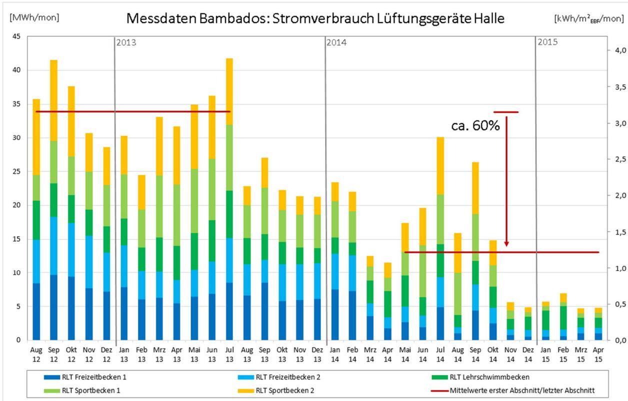
**Abb. 116: Beispiel Hallenbad Bambados: Reduzierung des Stromverbrauchs durch Betriebsoptimierung (ohne zusätzliche Investitionen)**
