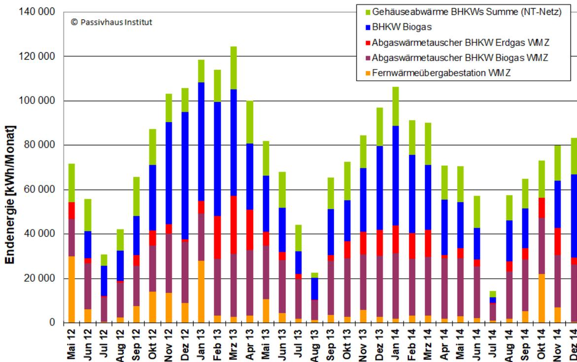
Abb. 8: Monatliche Verbrauchswerte der Wärmeversorgung des Lippe-Bades nach den unterschiedlichen Wärmelieferanten (ohne WP) vom Mai 2012 bis Dezember 2014. NT-Netz: Hydraulikkreislauf zur Beckenwasser-erwärmung auf niedrigerem Temperaturniveau (Nutzung Gehäuseabwärme).
