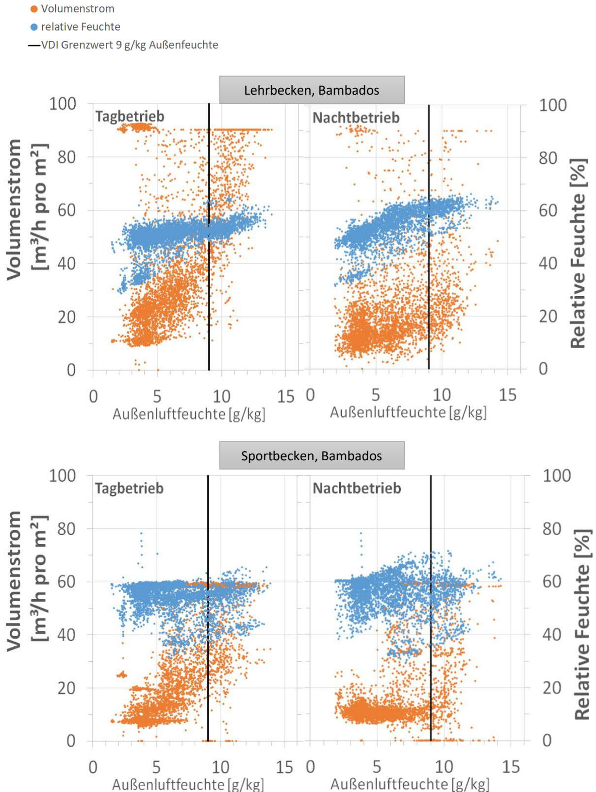
**Abb. 43: Bambados in Bamberg: Die gemessenen stundenmittleren Außenluftvolumenströme (orange) und relativen Raumlufffeuchten (blau) in Abhängigkeit der absoluten Außenluftfeuchte während den Öffnungszeiten (links) und nachts (rechts) für die Lehrschwimmbecken (oben) und die Sportbecken (unten). Daten von Mai 2014-April 2015, ohne die sommerliche Revisionszeit.**
