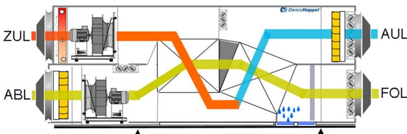
**Abb. 38: Schwimmhallenlüftung in reinem Außenluftbetrieb, d.h. ohne Umluft (Grafik © FlaktGroup Deutschland GmbH)**
