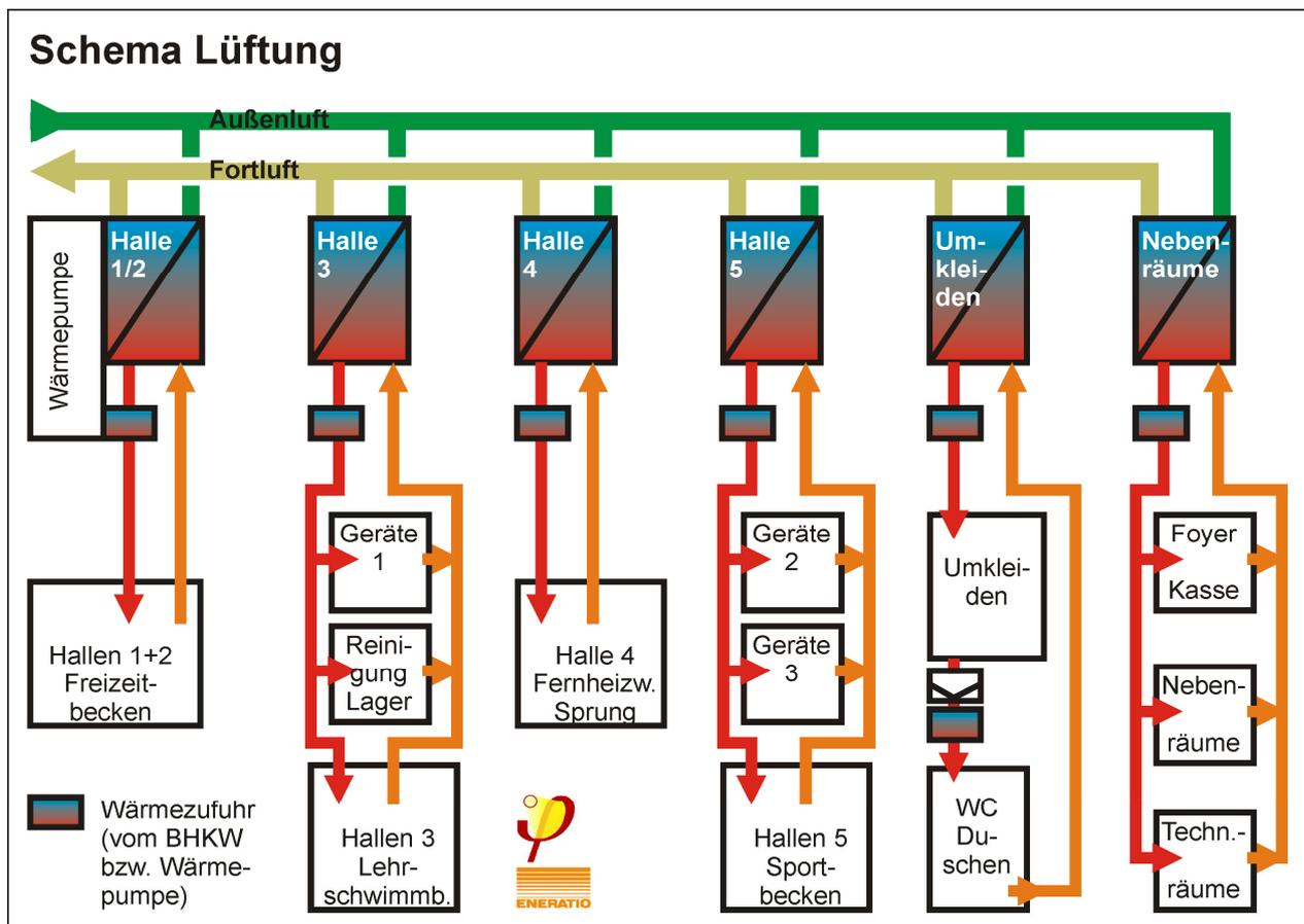
Abb. 4 Schematische Darstellung der Lüftungstechnik des Hallenbades. Aus [Peper/Grove-Smith 2015].
