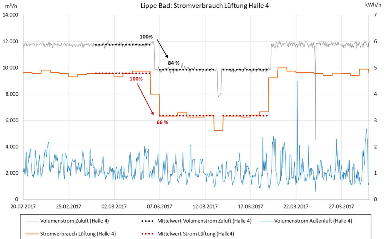
**Abb. 53:** Bei gleichbleibendem Außenluftvolumenstrom wurde der Zuluftvolumenstrom reduziert. Dadurch sinkt der Stromverbrauch des Lüftungsgerätes signifikant.
