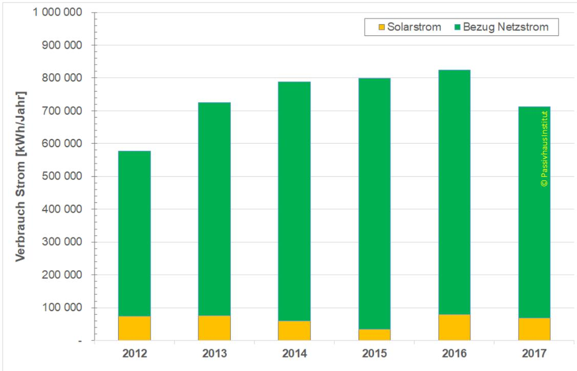
Abb. 15: Gesamter jährlicher Strombezug des Lippe-Bades 2012 bis 2017 aufgeteilt nach den Bezugsquellen (Netz und PV-Erzeugung).
