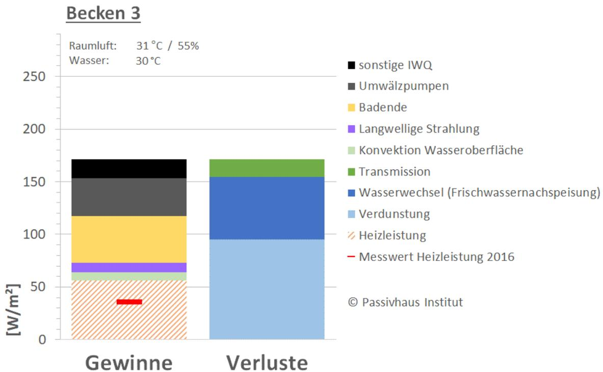
**Abb. 89: Berechnete Energiebilanz für das Becken 3 unter den gemessenen Betriebsrandbedingungen des Jahres 2016 (ausgenommen Sommerpause Juli und August). (Anmerkung: Die Effekte der Wärmerückgewinnung aus dem Abwasser, sowie das Füllwasser aus der Spülabwasseraufbereitung sind in der Frischwassernachspeisung berücksichtigt).**
