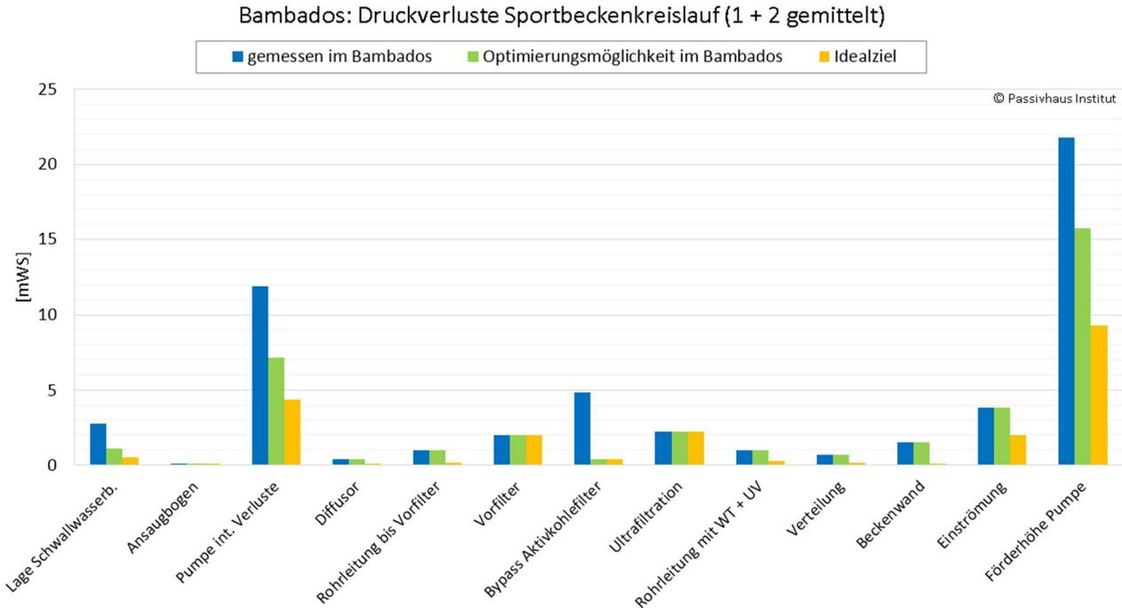
**Abb. 73:** Beispiel der Druckverluste einzelner Komponenten des Sportbeckenkreislaufs im Bambados Hallenbad: Gemittelte gemessene Druckverluste (blau), sowie deren Optimierungspotential durch Nachrüstung (grün) und, im Vergleich dazu, die im idealfall realisierbaren Druckverluste bei einer Neuplanung (gelb). Quelle: [Gollwitzer et al. 2015], [Kaluza 2014].
