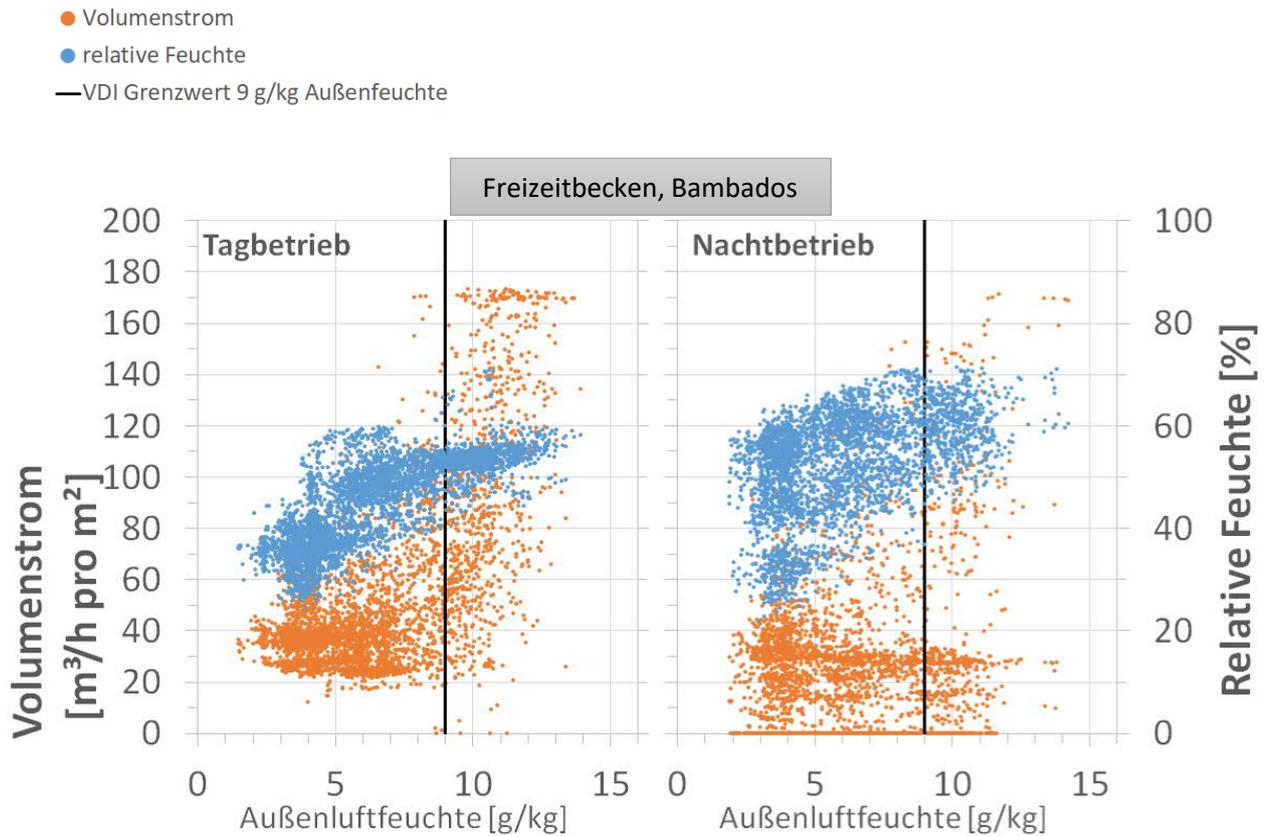
**Abb. 44: Bambados in Bamberg:** Die gemessenen stundenmittleren Außenluftvolumenströme (orange) und relativen Raumlufffeuchten (blau) in Abhängigkeit der absoluten Außenluftfeuchte während den Öffnungszeiten (links) und nachts (rechts) für den Freizeitbereich. Daten von Mai 2014-April 2015, ohne die sommerliche Revisionszeit. (Hinweis: Die Achse für den Volumenstrom ist in diesem Fall angepasst und doppelt so hoch wie in den vorherigen Grafiken)
