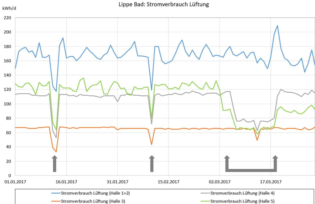
**Abb. 52:** Durch die Reduzierung der Umluft reduziert sich der Stromverbrauch der Lüftungsgeräte signifikant. Die Pfeile markieren die Zeiten der Versuche.
