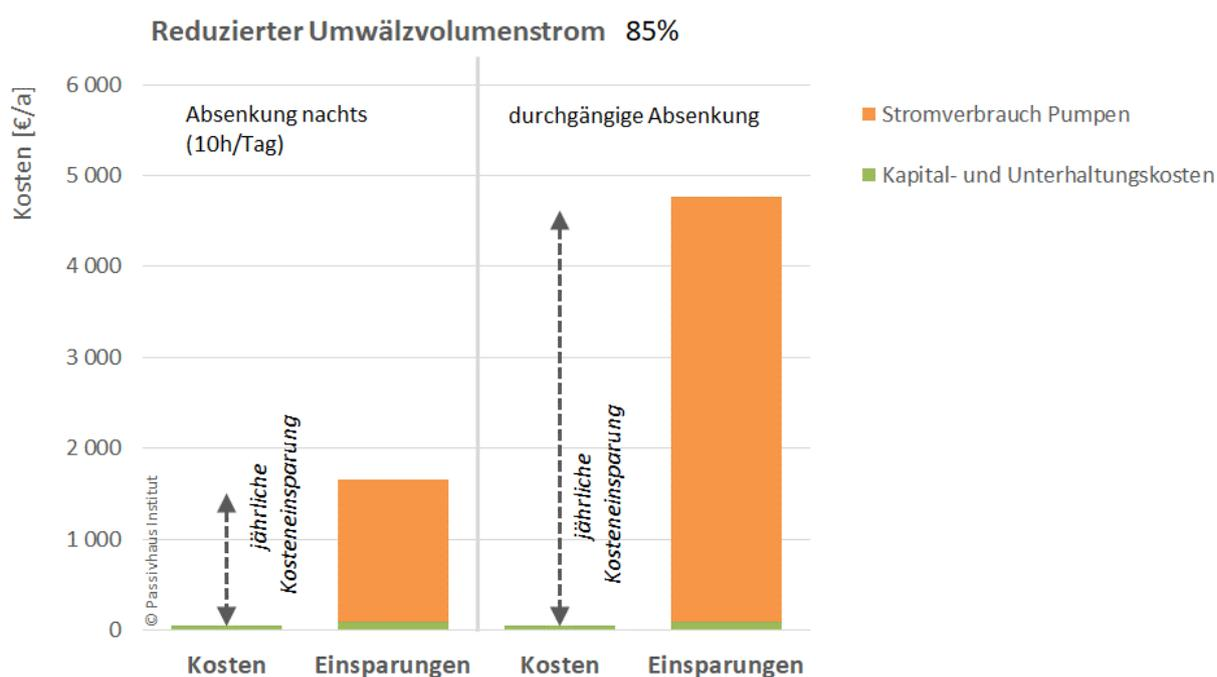
**Abb. 105: Beispielhafte Kosten-Nutzen-Analyse für reduzierte Beckenumwälzung außerhalb der Nutzungszeiten (links) bzw. durchgehend (rechts).**
