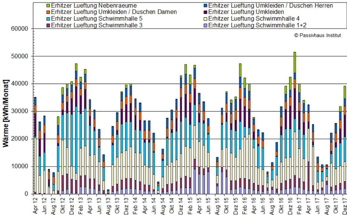
**Abb. 14:** Monatliche Wärmeverbrauchswerte für die Lufterwärmung der unterschiedlichen Bereiche (Hallen etc.) im Lippe-Bad von April 2012 bis Dezember 2017 (ohne WP).
