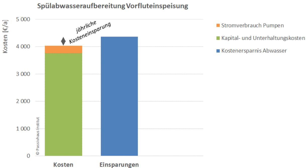
**Abb. 100: Beispiel einer Kosten-Nutzen-Analyse einer Spülabwasseraufbereitung mit Aufbereitung zur Einspeisung in die Vorflut (25m Sportbecken).**
